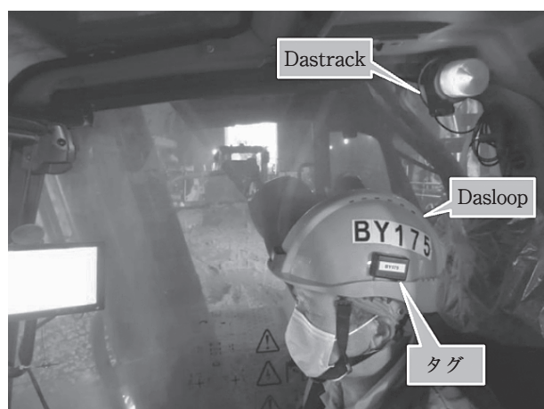
図 11 UWB モジュールはヘルメットに内蔵するか、後付けも可能
